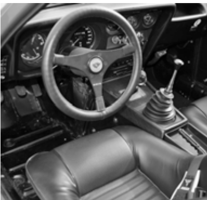
Bis auf wenige Details zeigt sich das Armaturenbrett noch relativ serienah. Das Raid-Lenkrad ist in der Mitte mit dem Conrero-Emblem versehen.
