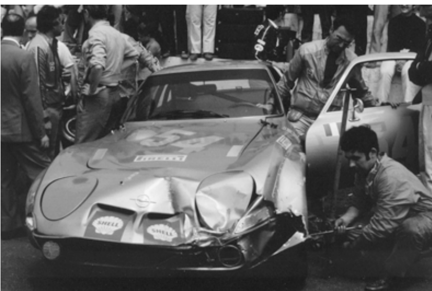
Ramponierte Nase nach dem Trainingsunfall von Pino Pica (Targa Florio 1971). Notdürftig wird die Front repariert und mit weißem Lack versehen für den Einsatz beim zweiten Training und im Rennen. Die Scheinwerfer werden in geöffneter Position fixiert.
