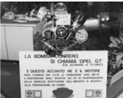
Das 2 Liter Triebwerk als Ausstellungsstück, hier noch in der Version mit dem seriennahen CIH-Kopf statt der später verwendeten Querstromversion (Cross Flow)
