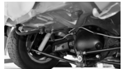
Blick auf das Differential mit dem von Conrero entwickelten Wattgestänge. Am Unterboden noch immer die ursprünglich goldfarbene Lackierung
