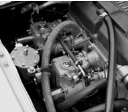
Statt mit Kugelfischer-Einspritzanlage jetzt mit zwei Weber Doppelflachstrom-Vergaser 45 DCOE. Trotzdem holt Carenini beim Überarbeiten des Motors standfeste 205 PS heraus.
