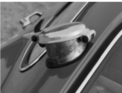
An allen vier Conrero GT umgebaut: Statt auf dem Heckblech befindet sich der Tankeinfüllstutzen mit Schnellverschluss an der linken C-Säule.
