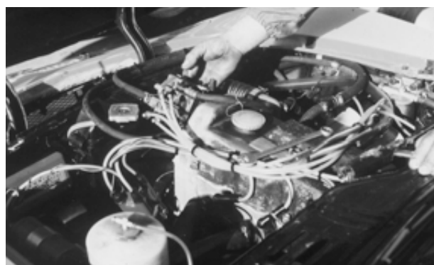
Mit Querstromkopf und Kugelfischer-Einspritzanlage werden bis zu 214 PS erreicht. Genügend, um Giorgio Pianta und Giorgio Schön (#34) mit 25 Sekunden Vorsprung bei der Targa 1972 die beste Trainingszeit bei den 2 Liter GT zu sichern. Nach einem Motorentausch versagt die Einspritzanlage jedoch am Rennsonntag ihre Dienste, Pianta und Schön können noch nicht einmal zum Start rollen.
